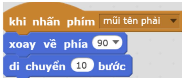
Hình 4: Chương trình xe tăng di chuyển qua phải khi nhấn phím mũi tên qua phải
